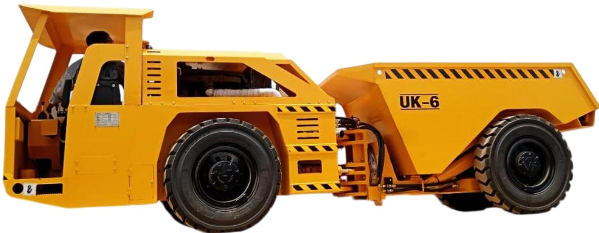
El DALI UK-6 es un camión estrecho de 6 toneladas que cabe en una galería de 2,5 m x 2,5 m. Diseñado con un compartimiento del operador sentado lateralmente para máxima comodidad del operador en aplicaciones que requieren operación tanto hacia adelante como hacia atrás.
